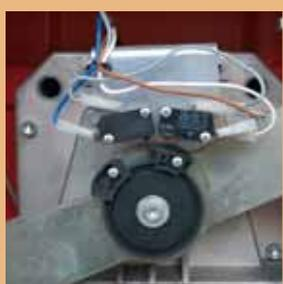
Trois micro-interrupteurs garantissent la précision des mouvements et des fermetures parfaites
